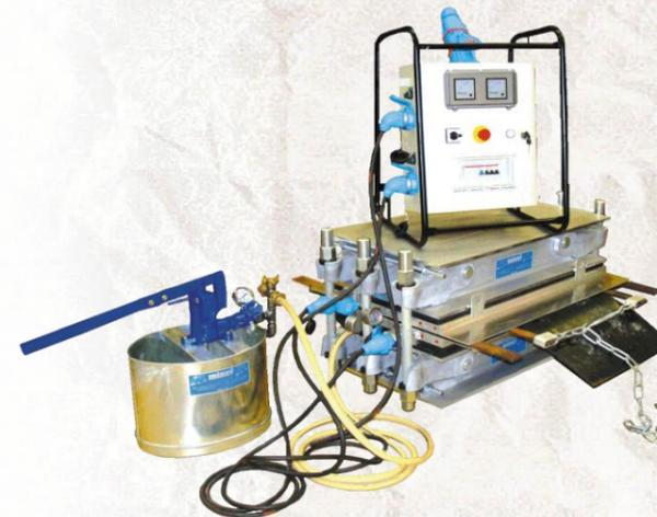
Окончательный вид пресса в сборе, с насосной станцией и станцией автоматического управления.
